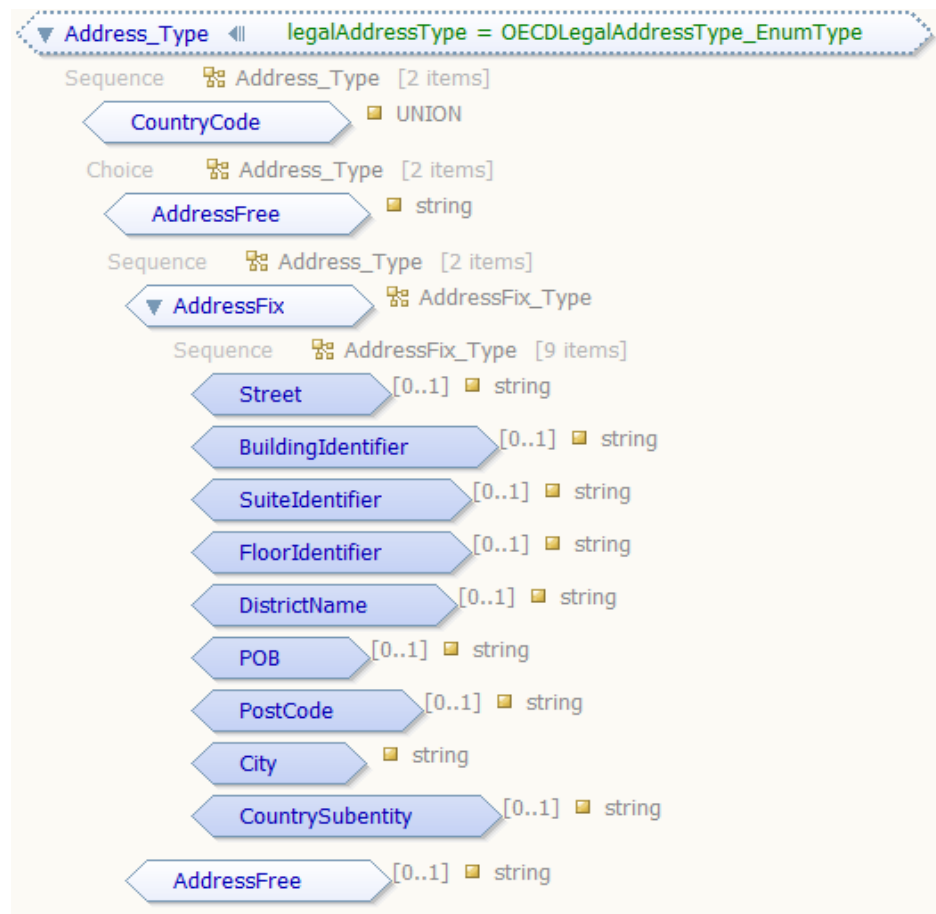
Paveikslėlis Nr. 7. CRS-DAC2-LT XSD – dalies Address_Type struktūra
